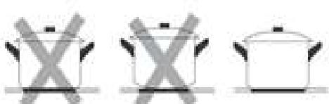
Verwenden Sie Kochgeschirr, dessen Durchmesser so groß ist wie die Grafik der gewählten Zone. Bei Verwendung eines Topfes wird eine etwas höhere Energie bei maximaler Effizienz genutzt.
